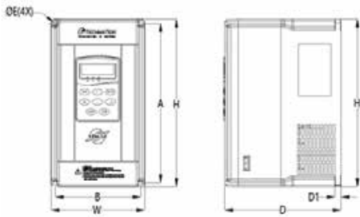
5.5~11kW(380V)安装尺寸
